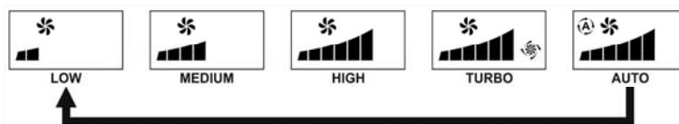
การทำงานของพัดลมในแบบอัตโนมัติ (FAN AUTO) พัดลมจะทำงาน โดยเปลี่ยนความเร็วของพัดลมตามความแตกต่างของอุณหภูมิห้องกับอุณหภูมิที่ตั้งไว้
